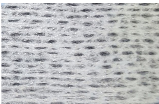
Рисунок 1 – Структура материала спанлейс
