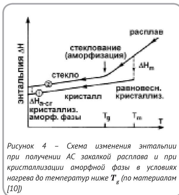
Рисунок 4 – Схема изменения энтальпии при получении АС закалкой расплава и при кристаллизации аморфной фазы в условиях нагрева до температур ниже  $T_g$  (по материалам [10])
